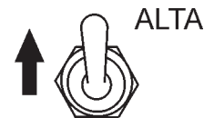
Figura 53. Interruptor de velocidad del motor (Alta)
